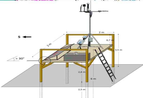
Plateforme équipé de panneaux solaires, batteries, équipements de mesures et Mat.
