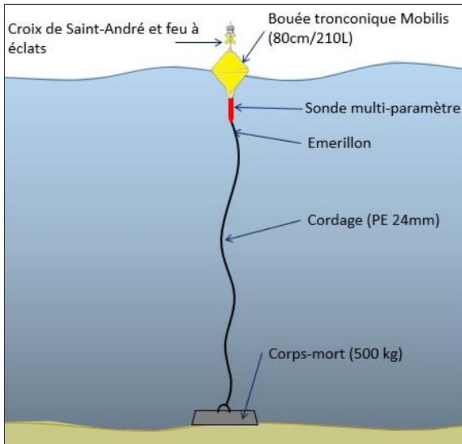
Figure 1 : Schéma de principe de la ligne de mouillage
