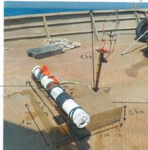
enregistreur acoustique positionné sur une platine en acier de 4,3m de long
