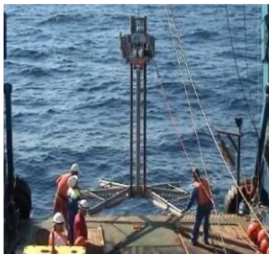
Figure 2. Photographie du vibro carottier GeoCorer
