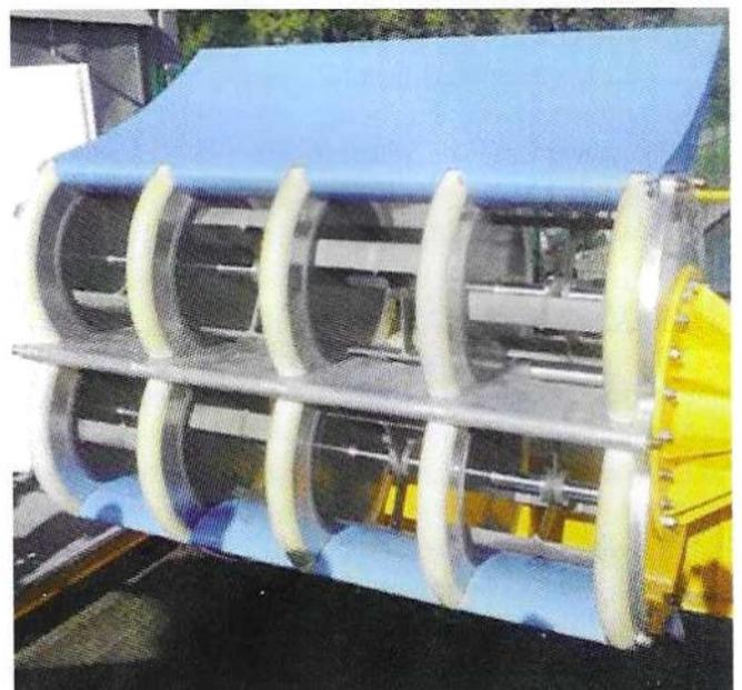
*Un type d'hydrolienne fluviale...*
